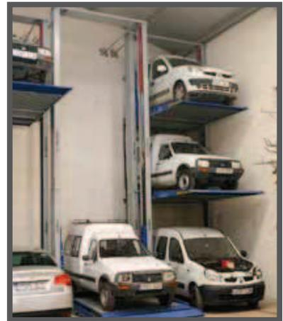
La séquence du transit de la charge de la plateforme supérieure à la plateforme inférieure, également appelé « système par paquets », montre le format réduit du produit même lorsqu'il est en fonctionnement.
