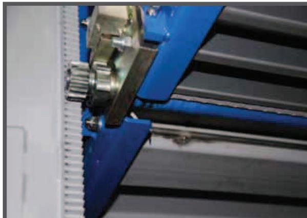
La photo détaillée du support de la barre de torsion montre que la position du pignon par rapport à la crémaillère se règle en décalant le support.
