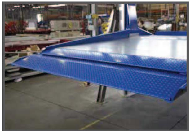
La descente de la plateforme supérieure au moyen de la rampe appropriée correspond à une manœuvre très aisée, puisque ces deux éléments sont solidaires.
