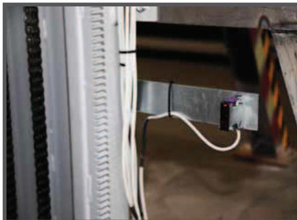
La machine est dotée d'un système de photocellules de contrôle du positionnement des véhicules sur les plateformes. Ce système sécurise le produit de façon remarquable et évite les éventuels dommages dont pourraient faire l'objet les plateformes lorsque des véhicules sont à bord. Le système fonctionne à l'aide d'un dispositif émetteur et d'un dispositif réfléchissant situé sur la partie opposée, qui forment une barrière. Lorsque le rayon s'éteint, les plateformes sont immédiatement bloquées.
